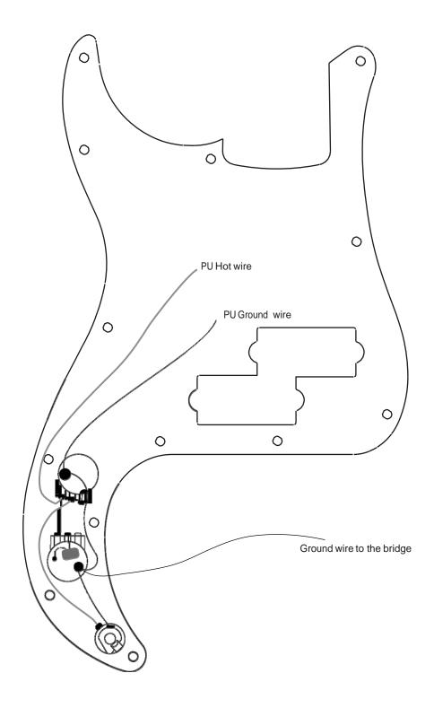
Solo PBK-1 Wiring Diagram
