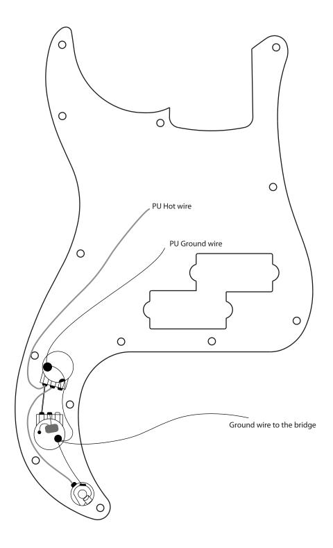
**Solo PBK-1 Wiring Diagram**
